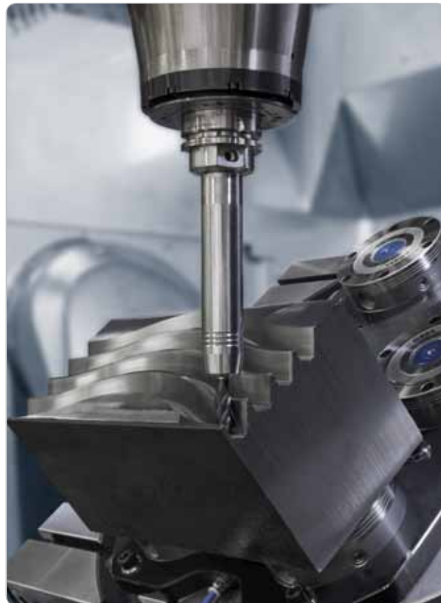
Obr. 5 S priamym upnutím obrobkov sú upnuté priamo v rýchlovýmennom paletovom module použitím upínacích čapov.
