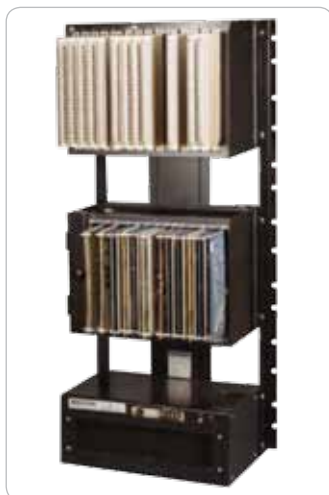
Obr. 1 Modicon 084, prvý PLC na svete – 256 I/O, 32 kB pamäť
