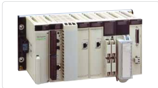
Obr. 2 Modicon Premium, veľké PLC vhodné pre rozsiahle riadiace úlohy nielen v diskretnej, ale i v procesnej výrobe
