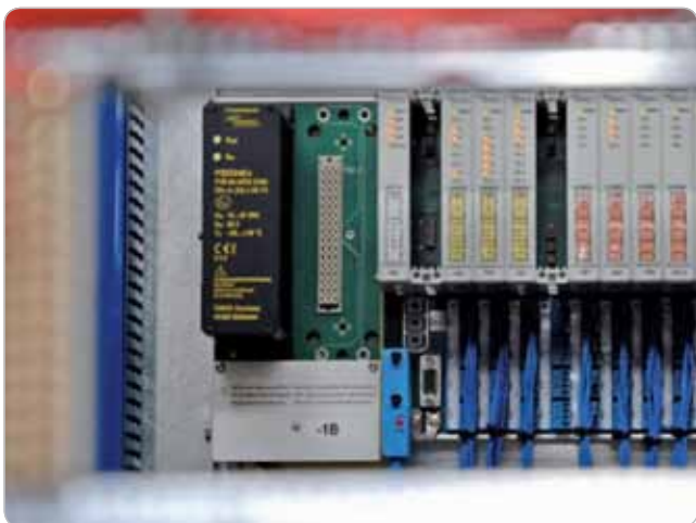
Obr. 1 Systém vzdialených V/V excom prináša na malom priestore až 128 binárnych alebo 64 analógových kanálov.
